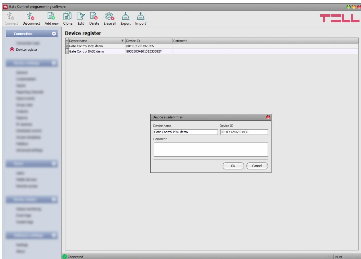
Version 9 fyller automatiskt i **Device ID** när ni lägger till modulen, skulle detta ej ske finner ni **Device ID** och **SIM ID** på fliken **Status monitoring**.
