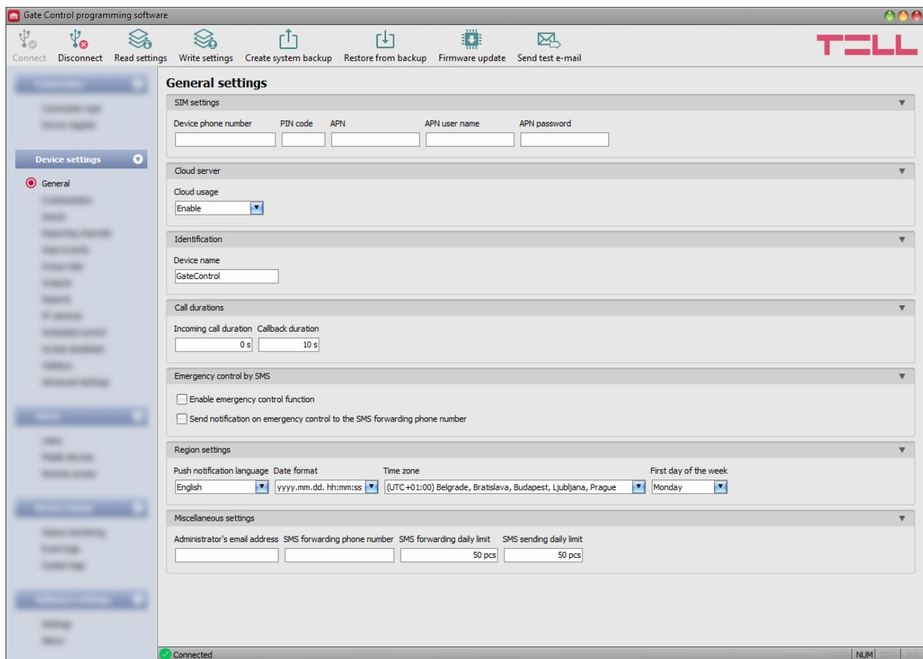
Om modulen behöver nås via internet och det är aktiverat på SIM-kortet behöver APN anges samt ändra **Cloud usage** till **Enable**.
